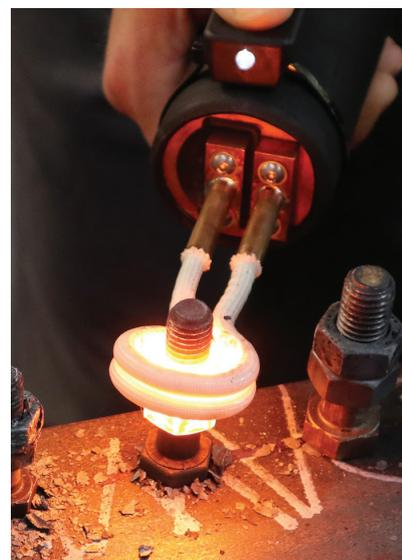
Chauffage par induction de pièces métalliques avec bobine ronde.
