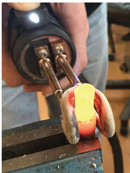
Soudage par induction de tubes de cuivre avec soudure à l'argent.
