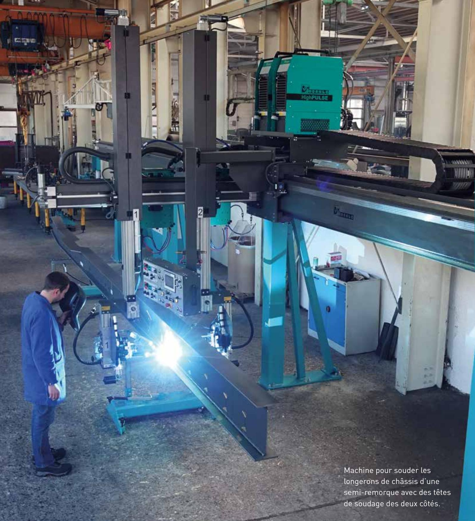
Machine pour souder les longerons de châssis d'une semi-remorque avec des têtes de soudage des deux côtés.
