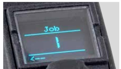
Les tâches préprogrammées peuvent être sélectionnées avec le bouton de commande. Tous les paramètres des travaux peuvent être programmés en fonction des besoins de l'utilisateur. Des résultats de soudage reproductibles parfaits sont garantis dans tous les réglages.
