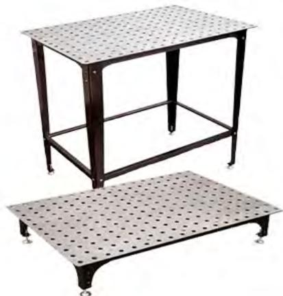
Le système FixturePoint est idéal pour la mise en place de cadre 2D. Utilisez les accessoires pour travailler confortablement, en toute sécurité et de manière efficace pour améliorer la qualité du travail et de la productivité. Les brides FixturePoint et les composants peuvent être insérés dans les trous de 16 mm sur la table de 900 x 600 mm pour une flexibilité totale dans la fixation modulaire. La capacité de charge statique maximale est de 120 kg.
