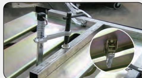
Les serre-joints MagSpring™ peuvent être insérées dans les fentes de 28 mm du plateau de la table Nomad™ pour un bon maintien. La mâchoire magnétique en V-Pad tient sous la table pour maintenir la pince en position.
