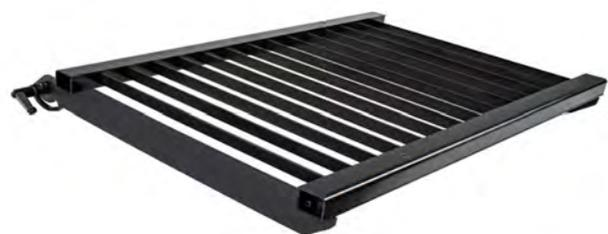
Le plateau pour découpe au plasma supporte jusqu'à 45 kg sur une surface de découpe de 457 x 711 mm avec 14 lattes en acier réversibles / remplaçables. La largeur généreuse de 46 mm entre les lames de découpe offre un grand espace pour le serrage. Les lames sont maintenues en place pour maintenir la rigidité pendant le travail. Coupez, bridez et fixez sur un poste de travail mobile pratique à une hauteur de travail idéale et uniforme.
