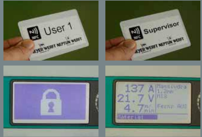
Carte utilisateur NFC pour le fonctionnement de la machine et carte superviseur NFC pour les paramètres supplémentaires
