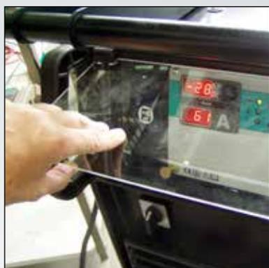
Couvercle de protection pour le panneau de commande de la machine
