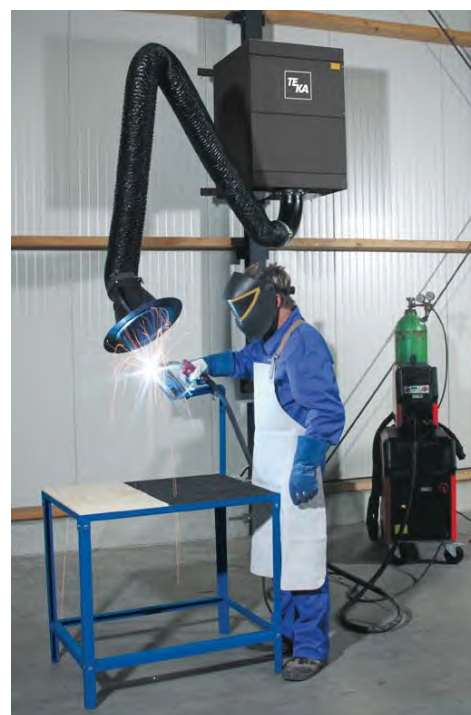
Exemple d'application : CareMaster mural avec plaque de buse supplémentaire sur la hotte d'aspiration
