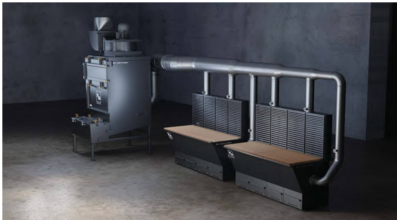
Exemple d'installation : Deux tables de meulage (2 000 mm) avec un cyclone à voie humide
