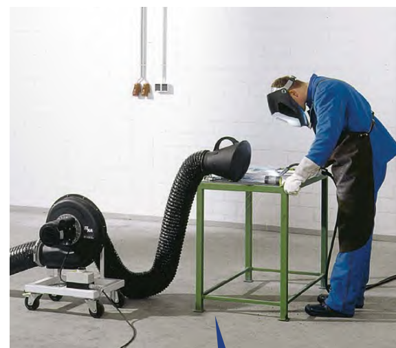
Exemple d'application : Ventilateur mobile
