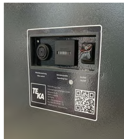
Commande intuitive avec compteur d'heures de service et avertisseur sonore
