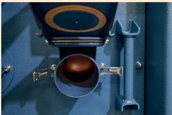
Raccordements frontaux pour jusqu'à 6 flexibles
