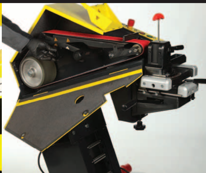
Bande abrasive automatiquement à la bonne tension
