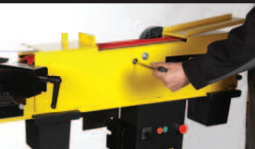
Réglage simple du chemin de bande
