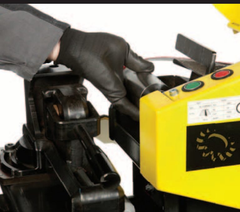
Changement simple du cylindre à poncer
