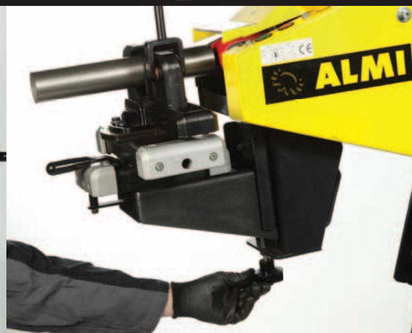
Possibilité de régler la table en hauteur
