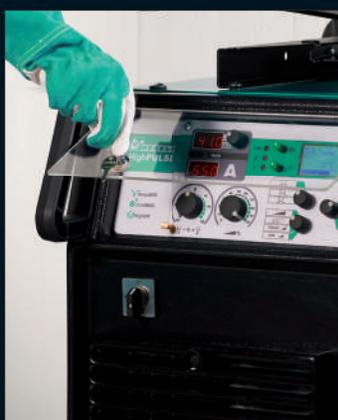
Panneau de commande verrouillable et transparent pour plus de sécurité sur le chantier et dans l'atelier. (option)
