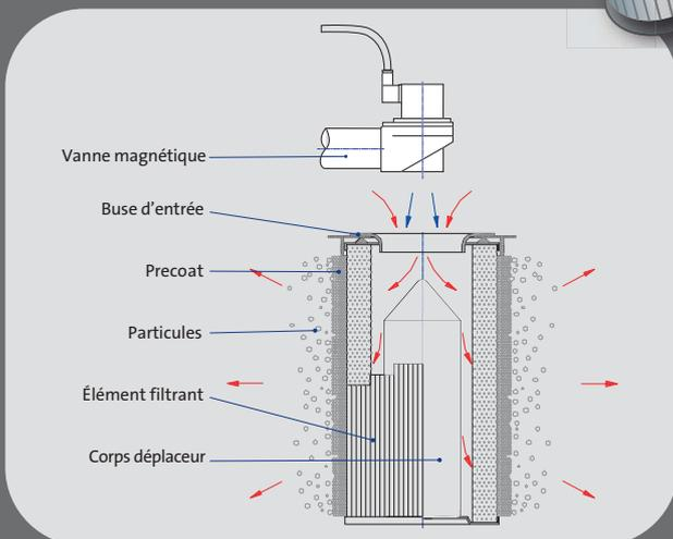
TEKA intègre en usine dans presque toutes les unités de cette catégorie un système de dépeussierage entièrement automatique : le système POWER-SPRAY commandé par microprocesseur! Au lieu des 8 bars habituels avec les buses d'injection/rotatives, seuls 4 bars d'air comprimé suffisent pour le dépeussierage. Vous n'aurez donc pas de frais consécutifs dus aux buses rotatives, souvent sujettes à l'usure.
