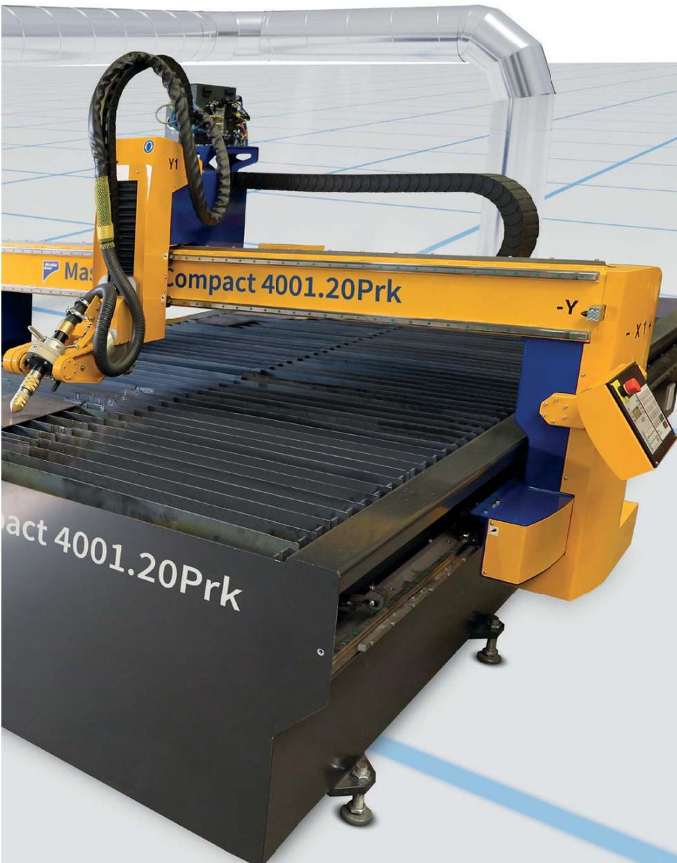
*Les tables d'oxycoupage de TEKA ont une structure modulaire et sont disponibles en série avec une dimension entre 2 et 24 m<sup>2</sup>.*
