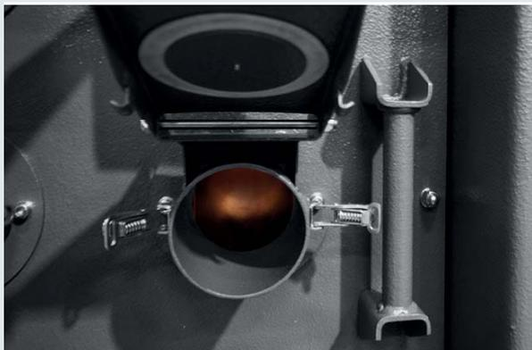
Raccordements frontaux pour jusqu'à 6 flexibles
