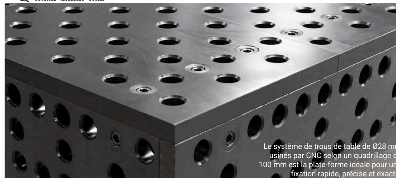
Le système de trous de table de Ø28 mm usinés par CNC selon un quadrillage de 100 mm est la plate-forme idéale pour une fixation rapide, précise et exacte.
