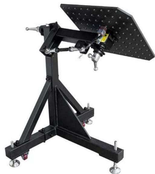
Le manipulator utilise deux axes de rotation et un axe d'inclinaison pour positionner votre pièce à l'endroit idéal. Pour de meilleurs résultats, placez toujours le centre de gravité de la pièce en ligne avec les deux axes de rotation pour obtenir un repositionnement à faible résistance.
