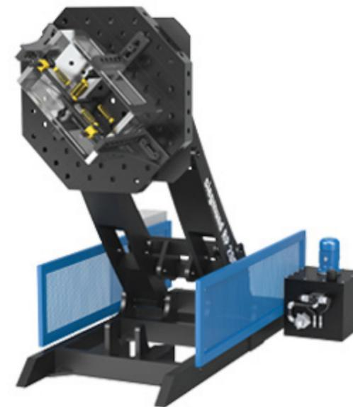
Les plaques à trous, les plateaux octogonaux et les poutres en U peuvent être adapter aux positionneurs 3 axes pour un bridage de vos pièces optimale sur le positionneur.
