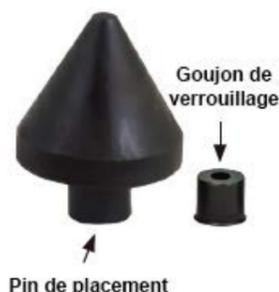
Utilisez le cône de positionnement pour localiser et positionner les tubes ronds horizontalement ou verticalement par rapport à l'axe central. Le cône de positionnement se positionne à l'intérieur du diamètre intérieur du tube [max. 41 mm] aux extrémités du tube, ce qui permet de localiser et de positionner l'axe central. Montez les cônes sur les accessoires BuildPro en utilisant l'une des deux bases interchangeables fournies :
