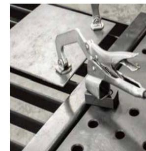
Il suffit de remplacer le goujon existant de la pince Inserta par l'adaptateur de montage pivotant.
