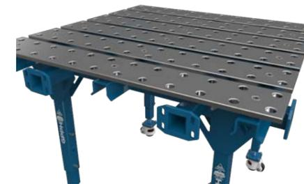
**MONTAGE FACILE DES OUTILS** - trous standards de Ø28 mm avec grille de 100x100mm. En outre, la conception de nos tables modulaires vous permet d'augmenter le nombre de places pour le montage des outils dans l'espaces entre les lames - une ergonomie accrue.
