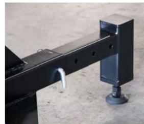
Les nouveaux stabilisateurs réglables offrent une plus grande stabilité lorsque vous travaillez avec des assemblages plus hauts et peuvent être rétractés lorsqu'ils ne sont pas nécessaires.
