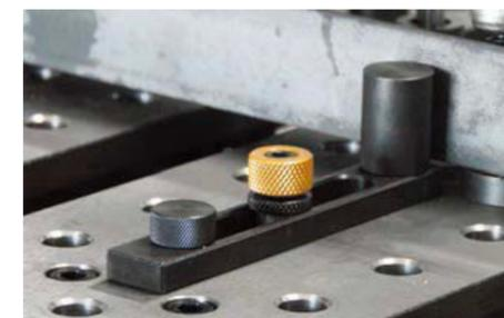
Au moins un boulon de bridage doit être utilisé avec le boulon de positionnement pour fixer les accessoires au plateau de table. Le boulon de positionnement ne peut pas être utilisé comme un élément de fixation indépendant.
