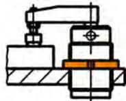
Avec écrous à encoches par le dessus
