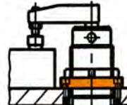
Avec bride filetée et écrou à encoches
