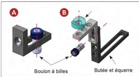
Maintient la pièce en place. Utilisez les équerres et les vés pour surélever et maintenir les pièces.
