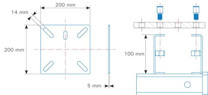
Monter sous la table avec des vis à encastrer (incluses)
