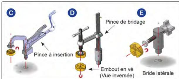
Serrage rapide des pièces plates, carrées, anguleuses ou arrondies. Maintient, arrête ou place les pièces à l'aide de la force de serrage horizontale.
