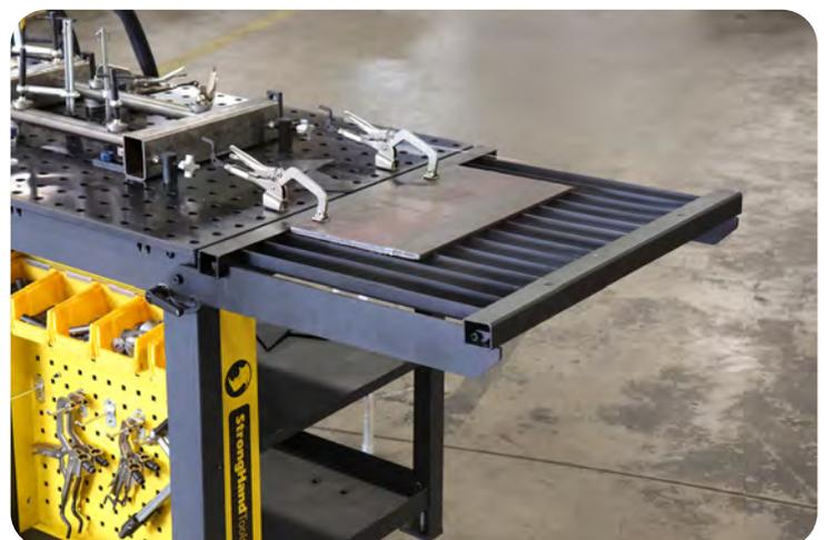
Insérez la pince à insertion dans le trou de 16 mm du plateau du Rhino Cart.
