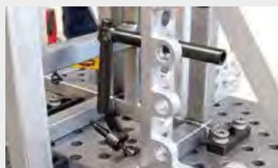
**Conditions de place restreintes.** Le serre-joint premium de DEMMELE<sup>®</sup> permet un serrage simple même aux endroits difficilement accessibles. Le patin avec prisme en V<sub>e</sub> assure une répartition centrée des contraintes.
