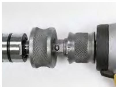
**Facilité d'utilisation et effort réduit :** Grâce au verrouillage de système DEMMELE entre les broches de serrage rapide à segments PPS et la visseuse à impulsions, l'insertion et le serrage ainsi que le desserrage et le retrait de la broche sont possibles d'une seule main.
