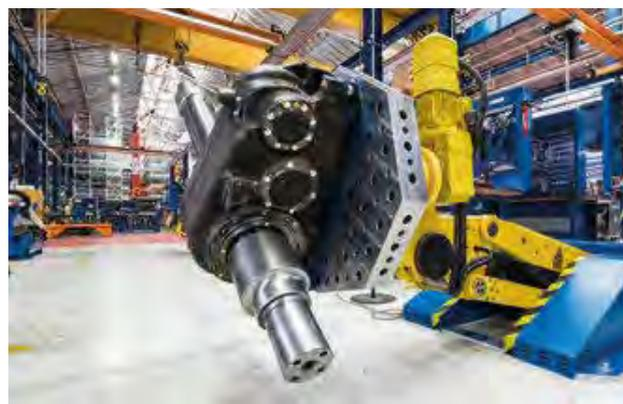
Le manipulateur, dont la hauteur et l'angle sont facilement réglables, permet d'acheminer des charges importantes en position idéale et garantit ainsi une position de travail ergonomique, même en cas de travaux de manutention impliquant des charges lourdes. Les travaux de montage peuvent ainsi être réalisés avec moins de fatigue et avec une précision élevée de manière constante.
