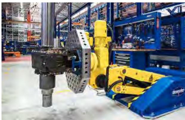
Avec son grand espace de travail et sa compacité, le manipulateur DEMMELER Ergonomix M® est le complément idéal des ateliers de production modernes. Les pièces à usiner sont parachevées avec un serrage sans pivotement supplémentaire grâce à la plage de pivotement brevetée allant jusqu'à 180°.
