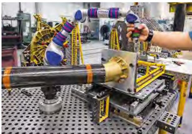
En raison de la grande précision dimensionnelle du schéma de perçage, des systèmes de positionnement conçus spécialement peuvent également être utilisés de manière flexible.
