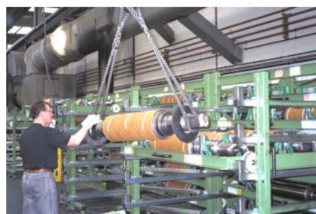
TwenTower pour les rouleaux Tiroirs lourds avec entrées pour les rouleaux à surface sensible
