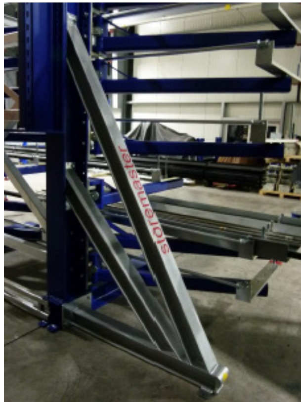
Le dimensionnement statiquement déterminé des éléments de support très stables. Les changements diagonaux assurent le système en permanence contre l'inclinaison et la perte de fonction pour une longévité garantie.
