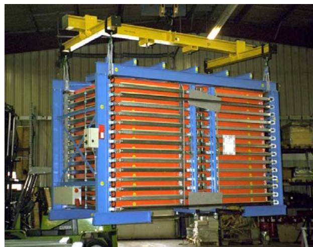
TwenTower pour les paquets de feuilles Jusqu'à 16 000 x 4 000 mm à 20 T Coulissement avec moteur
