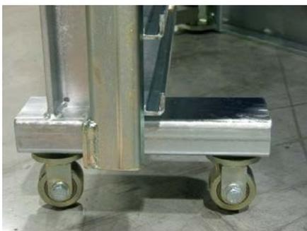
Fixation en L des panneaux latéraux à rouleaux coulissants contre le basculement grâce à un double support automatique à roues résistants selon la norme UVV (Breveté) sans frein de sol manuel, réglable en hauteur pour compenser les irrégularités du sol.
